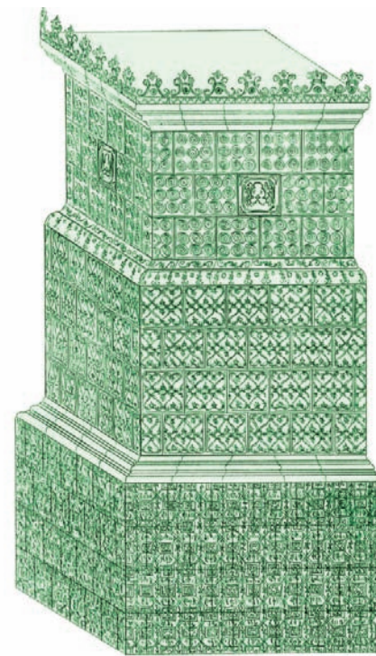
Піч з покоїв Мазепи на Гончарівці, облицьована зеленими полив'яними кахлями з рослинно-геометричним орнаментом. Реконструкція і малюнок Л. Мироненко, 2011 р.
