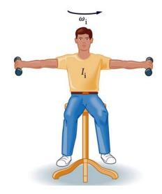
Le moment d'inertie de l'ensemble est la somme de  $I_{\it eb}$  (élève et banc) et des deux masses.
